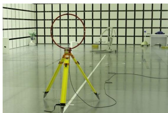
図 9-3 測定状況の例 測定距離 10m
