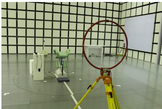
図 9-2 測定状況の例 測定距離 3m
