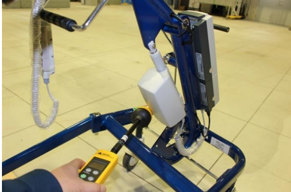
図 8-1 測定状況の例 電界測定
