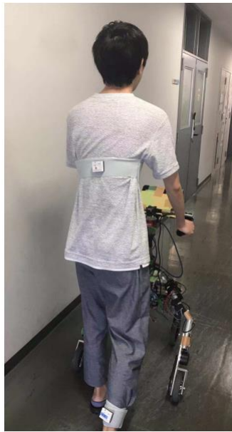
図 3-1 アシスト歩行器使用時の歩行計測
