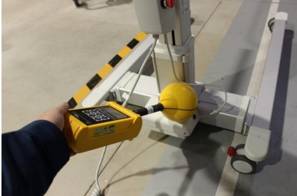
図 8-2 測定状況の例 磁界測定
