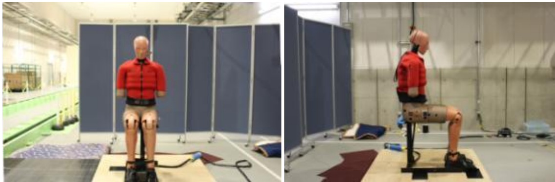
図 3-8 側方転倒（座位）に使用した人体ダミー
